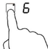
2. Toca el control del temporizador, el "10" se mostrará en la visualización del temporizador. y los "0" parpadea.
