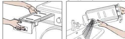
1. Tire de la cubierta del cajón y saque con cuidado el depósito.
