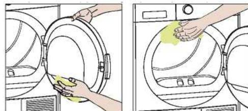
Abra la puerta de carga de la secadora y limpie todas las superficies internas y la junta con un paño suave y húmedo.
