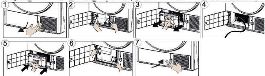
1. Abra la cubierta de la placa de protección como se muestra.
